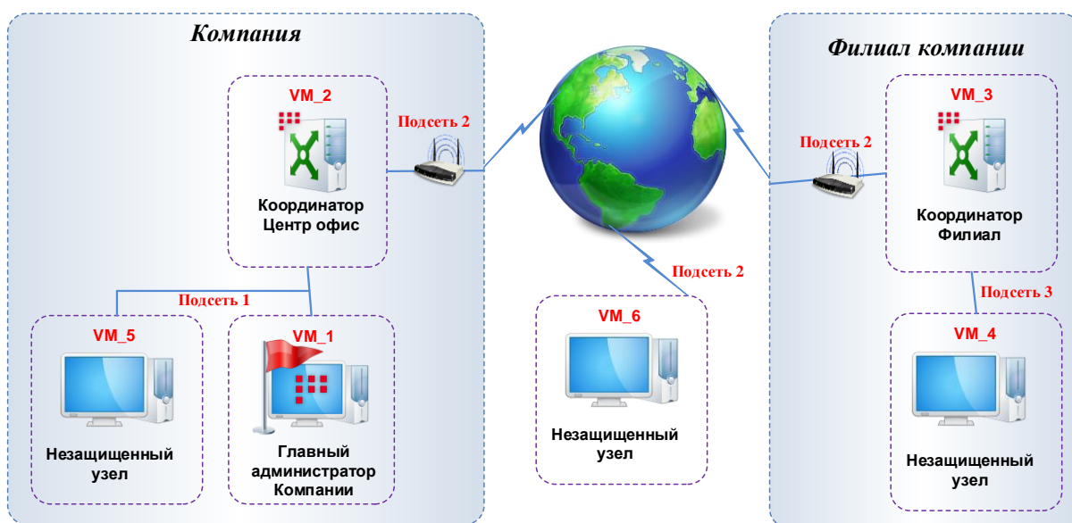
Рисунок 1 – Схема стенда для практического задания №4
